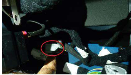
Tavan Üstyapı Elektrik Konnektörü
